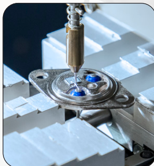
Wire pull & die shear testing
